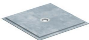
Toute en finesse, la dalle de douche fermacell Powerpanel TE se compose de deux plaques superposées. La plaque inférieure possède une épaisseur de 10 mm et reçoit, avec un débord de 50 mm en périphérie, la plaque supérieure de 25 mm d'épaisseur qui possède 4 pentes d'environ 2 %.
