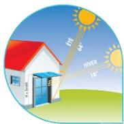
L'inclinaison optimale des modules de 5° garantit une meilleure protection solaire et un meilleur rendement énergétique, quelles que soient les saisons et la zone géographique. En effet, les brise-soleil protègent les fenêtres du rayonnement solaire direct, diminuent la charge de la climatisation en été, sans pénaliser l'éclairage naturel en hiver.
